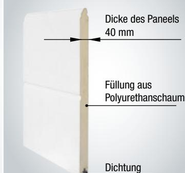
Die Tore von Beditom bestehen aus Segmenten von einer Dicke von 40 mm. Sie wurden aus doppeltem verzinktem Stahlblech, das mit freonfreiem Polyurethanschaum ausgefüllt wurde, hergestellt. Sie sind mit einem dauerhaften System der Dichtungen, die auf dem ganzen Umfang des Tors und zwischen den Segmenten angebracht wurden und welche wirksam vor Wind, Regen und Kühlung schützen, ausgestattet.
